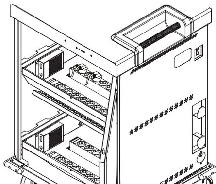
**2.** Collegare la spina dei dispositivi alla multipresa, facendo uscire il cavo di ricarica del dispositivo dal vassoio tramite i fori.
