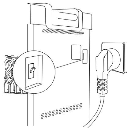
**4.** Collegare il carrello alla fonte di alimentazione e accendere l'interruttore sul lato destro. Inserire i dispositivi negli alloggiamenti. Collegare i cavi ai dispositivi.
